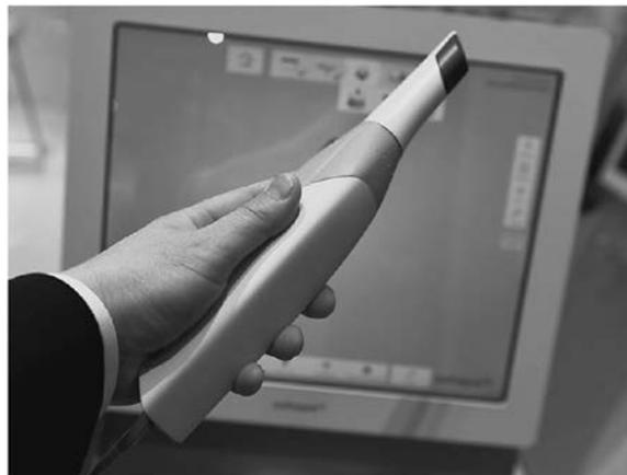
写真3 全体的に丸みを帯びたデザイン。カメラ部が細く丸くなっており口腔内へのアクセスが容易になった。
