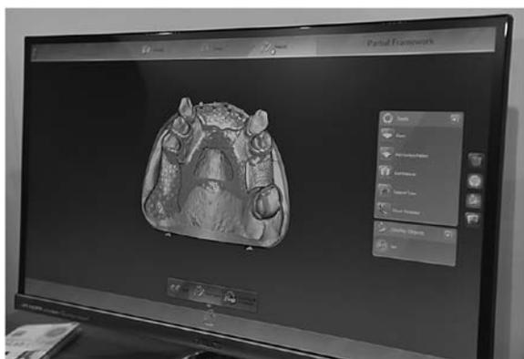
**写真17** inLab15はベーシック、パーシャルデンチャー、インプラントデザインの三種類が用意されている。写真はパーシャルデンチャー用ソフト。細分化が進むラボサイドソフト。
