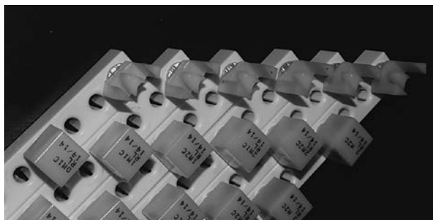
図4 milling後の各ブロック
