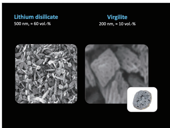
Fig. 3 CERECTessera™には、二ケイ酸リチウムとバージライトの二種類の結晶が含まれます。
