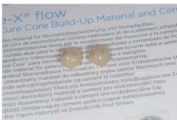
Fig. 17 透明性の比較、MT/A3 (左) と HT/A3 (右)。
