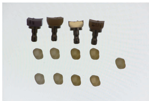
Fig. 20-1 珪酸リチウム系セラミックの透過光による比較。
